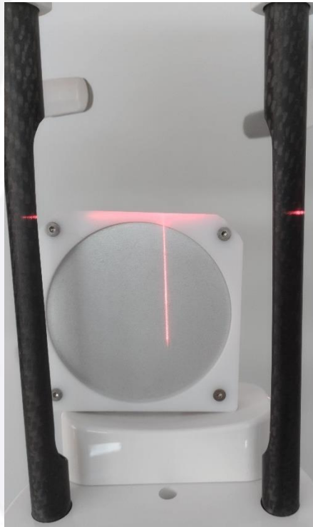
Rysunek 15. Fantom Pro-Dent Gamma w prawidłowej ustawionej pozycji do testów.
