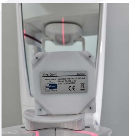
Rysunek 13. Prawidłowo ustawiony fantom do testów rozdzielczości wysoko i niskokontrastowej.
