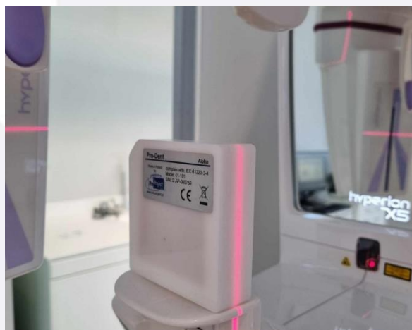
Rysunek 3. Pozycja prawidłowo ustawionego fantomu z naniesionymi liniami kła.
