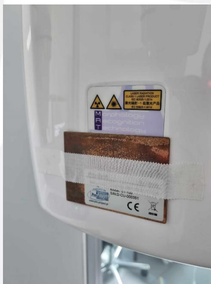
Rysunek 2. Filtr miedziany przymocowany do aparatu białym plastrem samoprzylepnym.
