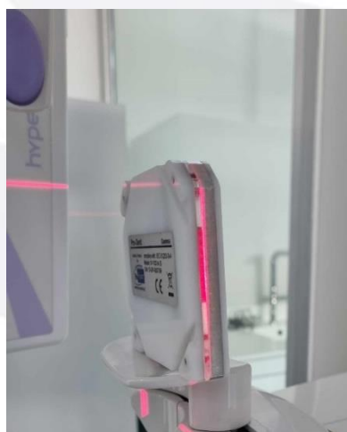
Rysunek 14. Prawidłowo ustawiony fantom z linią kła padającą na przezroczystą/lustrzaną część fantomu.
